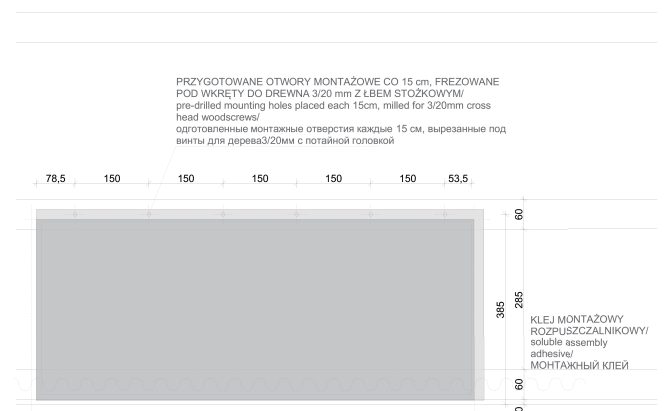
Rys. 15. Montaż pierwszego elementu Fig. 15. Assembling the first element Рис. 15. Монтаж первого элемента
